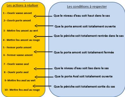
**5) Conclusion :** Il faudra placer à certains endroits du fleuve des écluses pour permettre la navigation des péniches sur le fleuve pour compenser les différences de niveau et réaliser une série d'opération pour permettre au bateau de passer de l'aval vers l'amont ou de l'amont vers l'aval.
