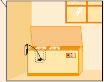
Détecteur pour congélateur Dépecte l'élévation suspecte de la température dans un congélateur.
