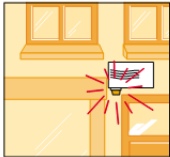
Sirène avec flash Signale l'intrusion par un son de forte puissance et par un flash lumineux.
