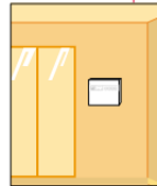
Centrale d'alarme reçoit les informations transmises par le détecteur, les analyse et déclenche les différents avertisseurs.
